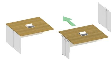
3. Com o Módulo Auxiliar devidamente fixado, faça o fechamento da plataforma com o pé lateral que foi solto no 1º passo.
